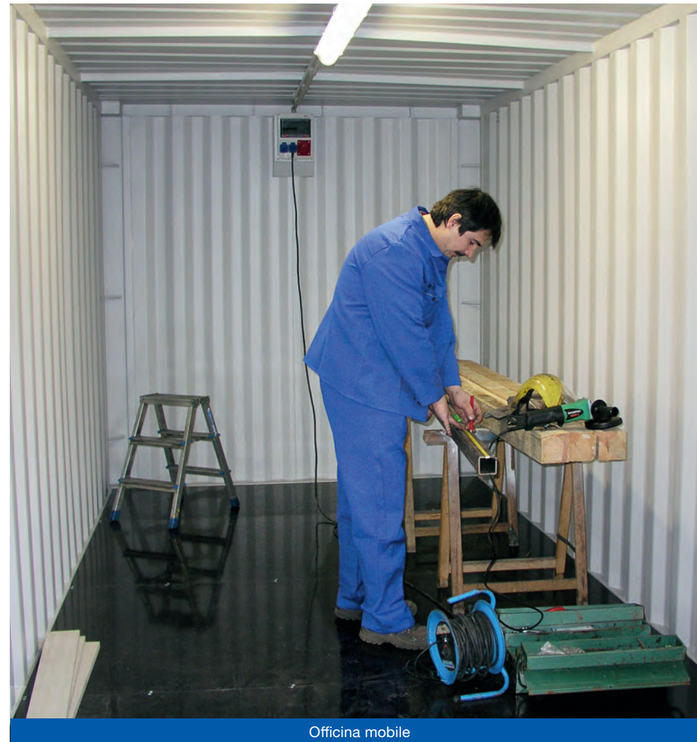
Plafoniera al neon e scatola di distribuzione con prese di corrente
