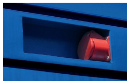
Presse elettrica CEE incassata nel telaio
